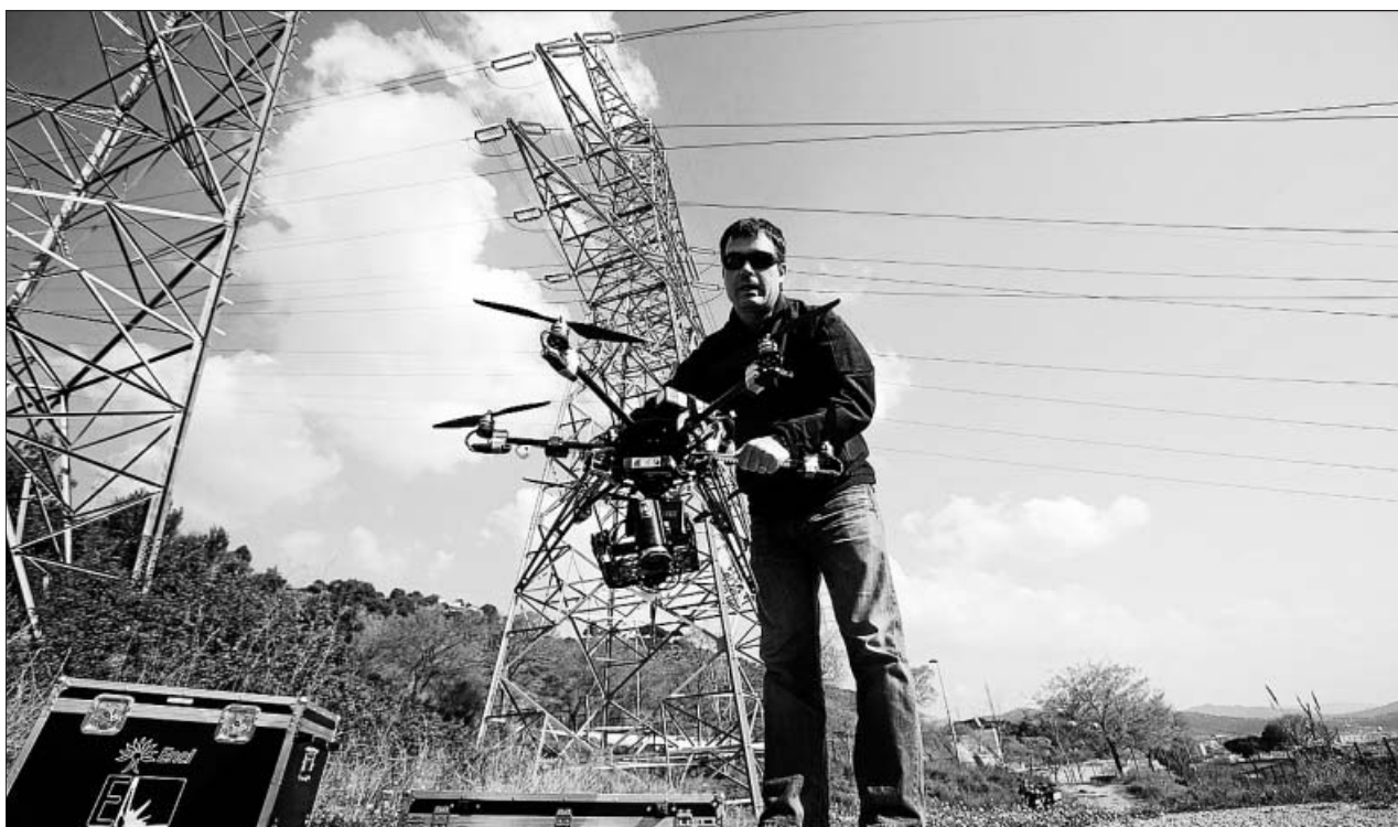
ELS 'DRONES' REVISEN L'ESTAT DE LA XARXA ELÈCTRICA. Endesa ha començat a utilitzar drons equipats amb càmeres d'alta resolució (foto) al Barcelonès per enregistrar i revisar l'estat de la xarxa. Aquests aparells aeris no tripulats, amb un cost aproximat de 9.000 euros, permeten inspeccionar aquelles línies de difícil accés. FOTO: ALEJANDRO GARCÍA / EFE
